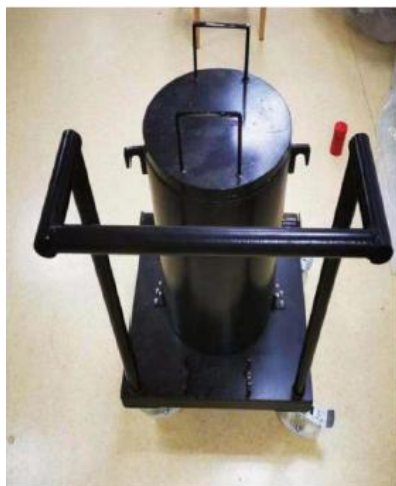
图 2-6 模体贮存铅罐以及转运小推车实物图
